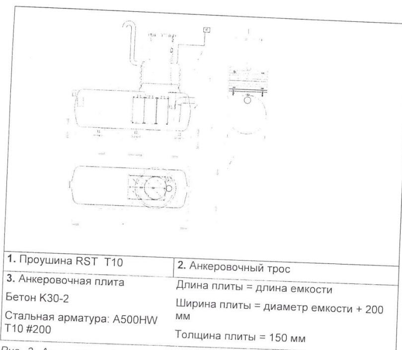
Рис. 3. Анкерка отделителя при высоком уровне грунтовых вод или при слабо несущих грунтах
